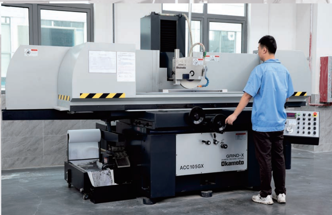
OKAMOTO 冈本平面磨床 ACC105GX 工作台行程: 1150*540
